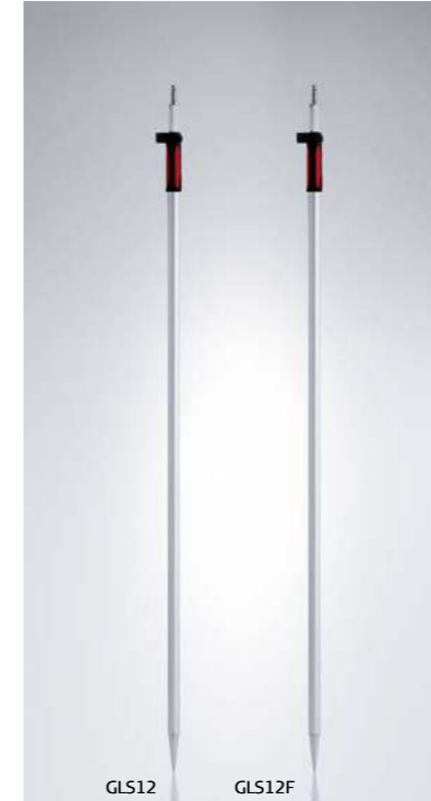
GLS12, ausziehbarer Lotstab Mit Druckverschluss gegen unabsichtliche Höhenverstellung. Geeignet für Prisma GRZ122 in Verbindung mit GNSS-Antenne. cm-Teilung, min. Länge 1,39 m, ausziehbar bis 2,0 m, Gewicht 950 g. Artikelnr.: 754391
