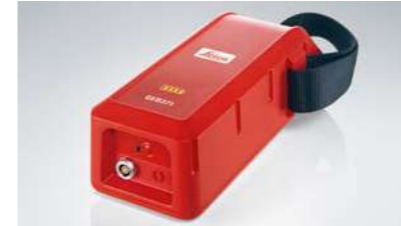
GEB373, externer Lithium-Ionen-Akku Leistungsstarker Akku für Langzeiteinsätze. 14,4 V / 289 Wh. Ladung nur mit Ladegerät GEV242. Mit einem Kabel GEV277 kann der Akku als USV (unterbrechungsfreie Stromversorgung) genutzt werden. Gewicht 2,3 kg. Artikelnr.: 905305
