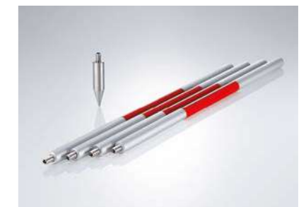
GLS115, Minilotstab 4-teilig mit Spitze. Mit 1/4"-Gewinde. Für Miniprismen GMP111 und GRZ101 sowie Flachprisma GPR105. Ermöglicht Prismahöhen von 10, 40, 70, 100 oder 130 cm. Für Prismen ohne Libelle ist zusätzlich eine anklippbare Libelle erhältlich (GLI115, 747895). Artikelnr.: 642106
