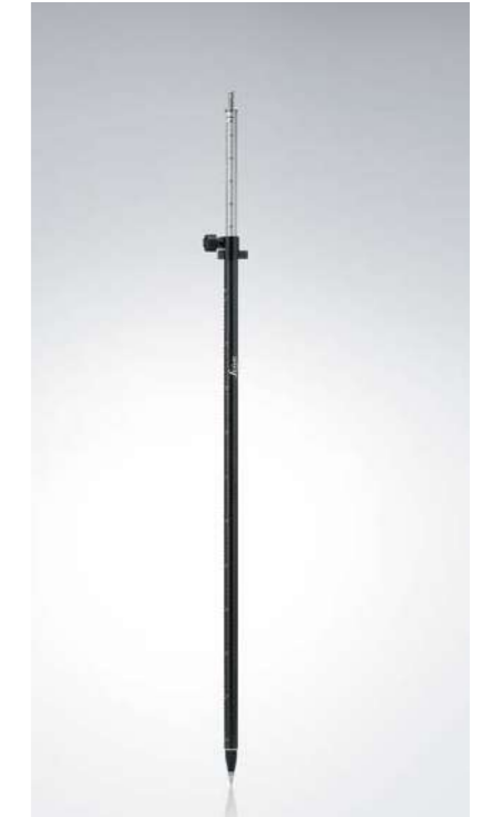
GLS101, Ausziehbarer Lotstab Reflektorstab aus Fiberkarbon/Aluminium mit Dreh- und Schnappverschluss gegen unabsichtliche Höhenverstellung. Zentimeter- und Fußteilung. Länge mind. 1,31 m, ausziehbar bis 2,3 m, Gewicht 1.230 g. Artikelnr.: 865472
